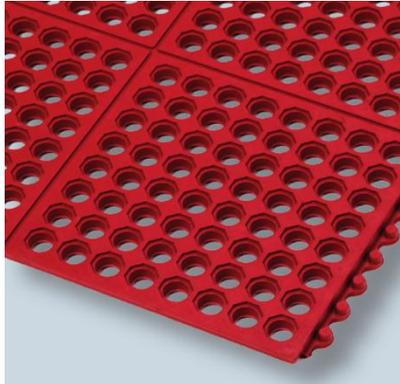
Variante Solid perforat : **negru** - standard ; **rosu** 75% nitril rezistent la lubrifianti, grasimi vegetale si animale recomandat in industria alimentara; **negru FR** 100% nitril, rezistent la uleiuri, ignifug rezistent la foc clasa Bfl-S1 recomandat in atelierele mecanice si de sudura.
