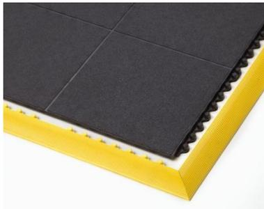
Variante Solid plin: **negru** - standard ; **negru FR** 100% nitril, rezistent la uleiuri, ignifug rezistent la foc clasa Bfl-S1, rezistent la alunecare R9 recomandat in atelierele mecanice si de sudura ; **negru ESD DIF FR** 100% nitril antistatic si ignifug rezistent la foc clasa Bfl-S1
